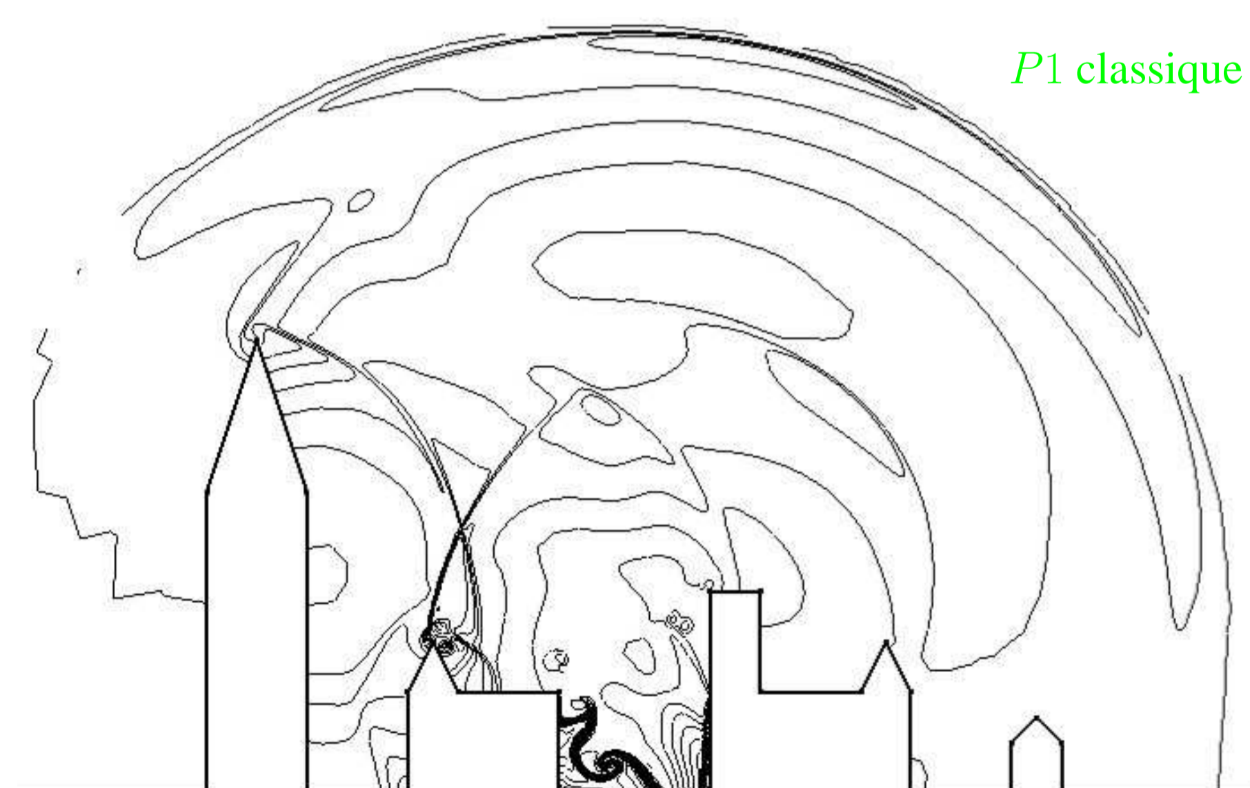
Isovaleurs et maillage pour l'interpolation P1 classique (10315 noeuds) - pour l'interpolation P1 conservative (14630 noeuds) - Isovaleurs de la solution de référence (1345824 noeuds)
